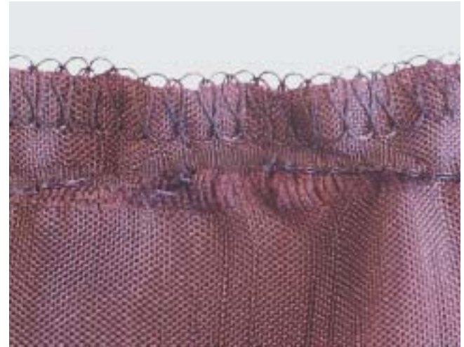
Schlechtes Nahtschiebeverhalten an einem DOB-Stoff
