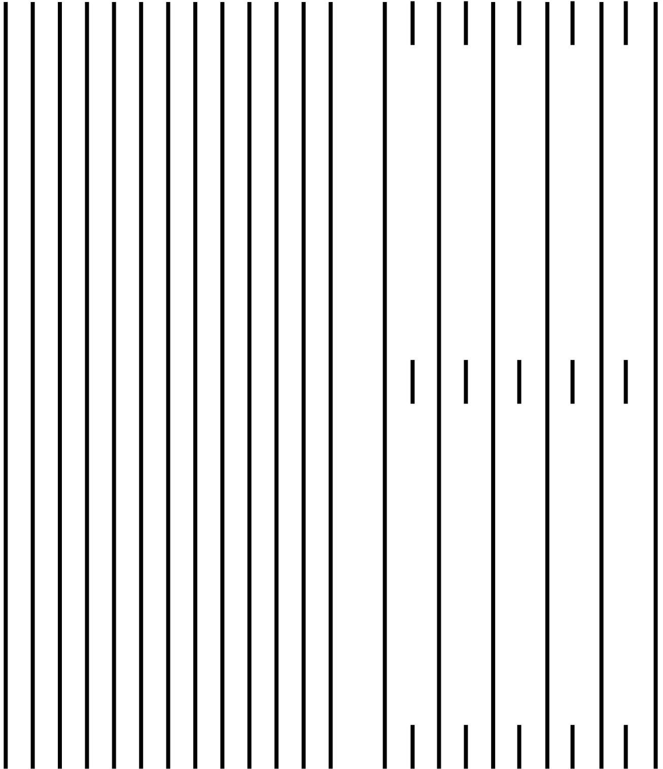
Am Nahtanfang und Nahtende werden je 4 Verriegelungsstiche ausgeführt. Zwischenräume nach Augenmaß ausfüllen.
