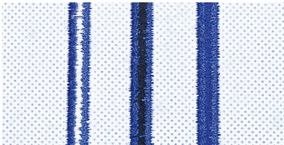
Korrekte Fadenspannung beim Stickern ( \frac{1}{3} der Fläche ist Unterfaden)
