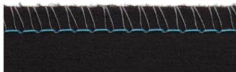
2-Faden-Überwendlichstich mit Stichlochbindung (Stichtyp 502)
