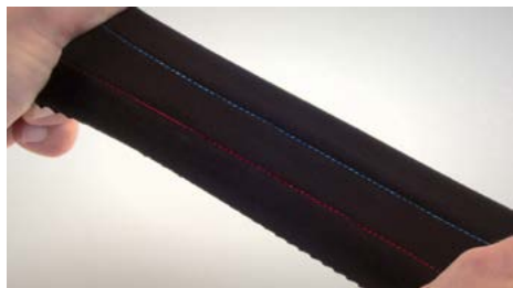
Dehnungsvergleich Umspinnzwirn und Sabaflex
