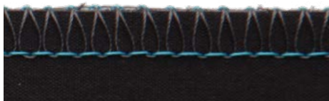
2-Faden-Überwendlichstich mit Kantenbindung (Stichtyp 503)
