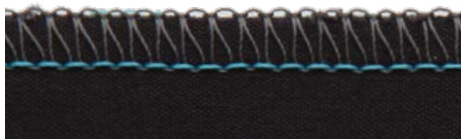
3-Faden-Überwendlichstich mit Kantenbindung (Stichtyp 505)
