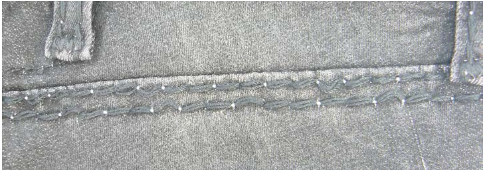
Nähte mit ungünstiger Fadenverteilung
