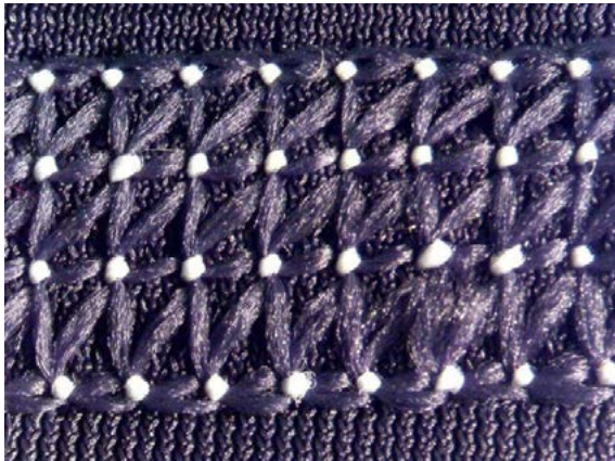
Korrekte Fadenverteilung beim Stichtyp 607: Ansicht der Nahtunterseite
