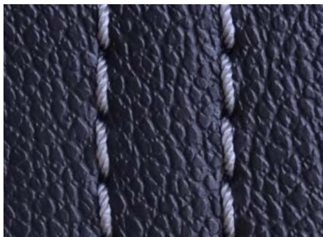
Zweinadelnaht mit 2 Z-Zwirnen
