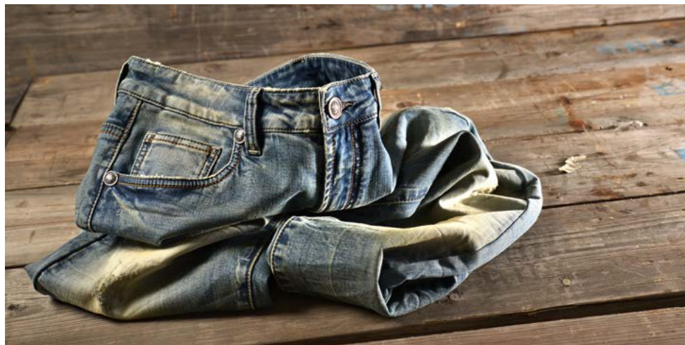
Spezielle Waschbehandlung an Jeans (partiellcs Schmirceln, Bürsten und Sprühen)
