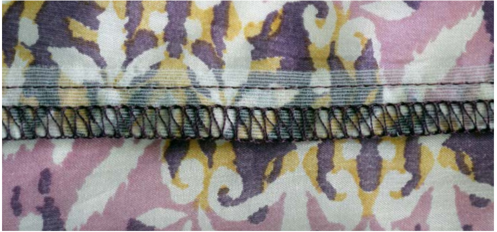
Mit Einlage beklebte Nahtlinie
