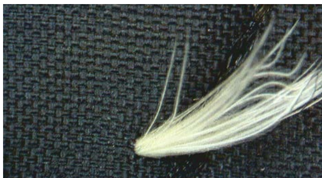
Austritt der Feder aus dem Material
