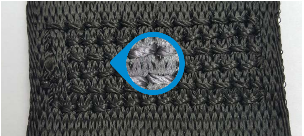
Zwirndrehung bei multidirektionaler Naht (Mikroskop)
