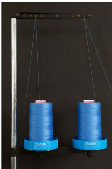
Korrektur Ablauf der Conen durch Einsatz von Spulteller
