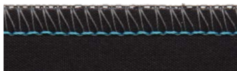
3-Faden-Überwendlichstich mit Stichlochbindung (Stichtyp 504)
