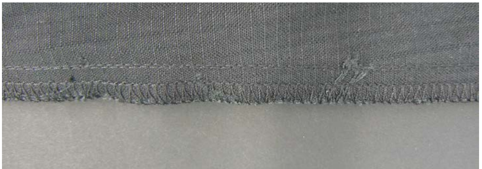
Ungleichmäßige Nahtzugabe aufgrund eines stumpfen Messers
