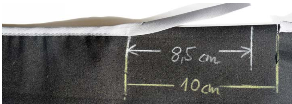
Maschineneinstellung – zu strammes Einfassband
