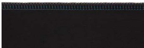
Nahtunterseite des Stichtyps 514
