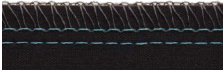
4-Faden-Überwendlichstich (imitierter Sicherheitsstich) (Stichtyp 512)
