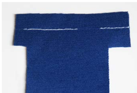
Prüfling mit gerissener Naht
