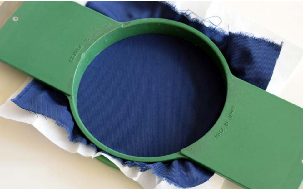
Stickvlies und Stoff eingespannt in Rahmen
