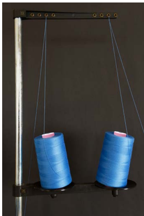
Schräg stehende Conen durch Fehlen der Spulteller (behinderter Fadenabzug)
