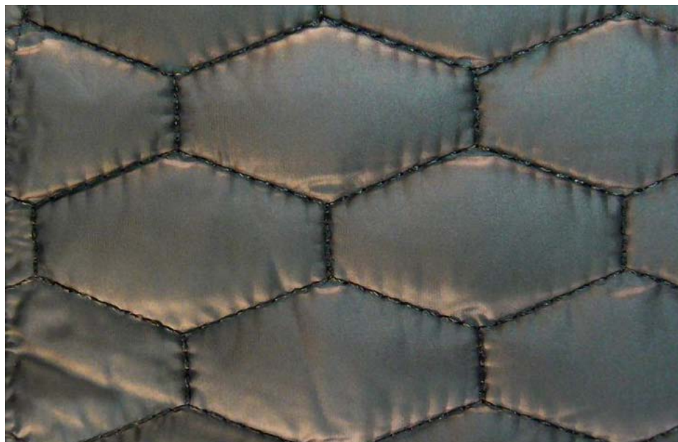
Daunenjacke genäht mit Multifilament, Serafil fine 180 (120/2)
