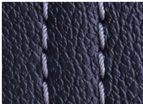
Zweinadelnaht mit S- und Z-Zwirn
